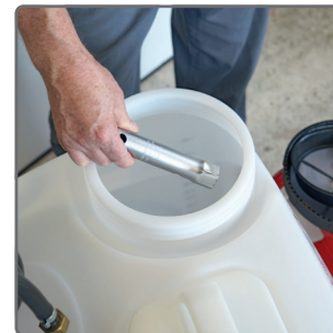
Rücklaufschlauch lösen Release return hose Libérer le tuyau de retour Rilasciare il tubo di ritorno
