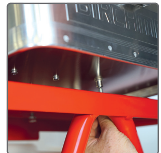
Mit Abstandhalter anschrauben Screw on with spacer Visser avec entretoise Avvitare con il distanziale
