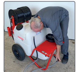
Rücklaufschlauch entfernen Remove return hose Retirer le tuyau de retour Rimuovere il tubo di ritorno
